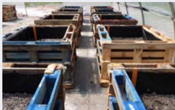
Bacs expérimentaux en milieu contrôlé contenant du sol et un apport de différents types de MO en surface (les quantités épandues ont été basées sur les données de littérature scientifique (Chabaliér et al. 2006))
