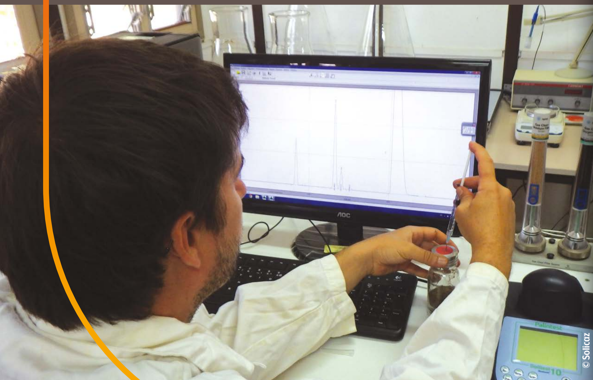
Des analyses d'activités microbiologiques du sol sont faites en laboratoire en Guyane, par chromatographie en phase gazeuse.
